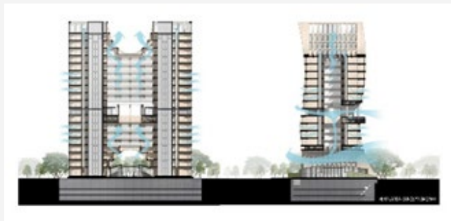
ภาพที่ 17 อาคาร Sindhorn Kempinski และภาพตัดของอาคารแสดงการระบายอากาศ (Archdaily, 2024)
