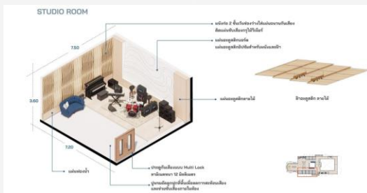
ภาพที่ 27 : รายละเอียดและแบบขยายห้องซ้อมดนตรี
