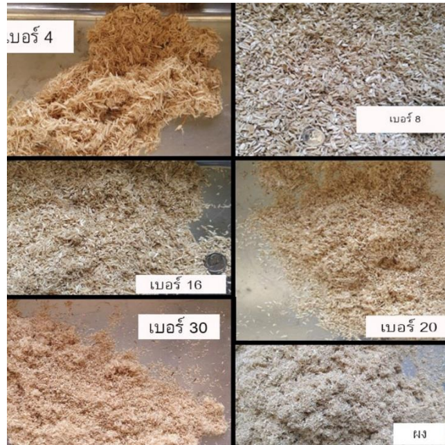
ภาพที่ 1 การบดแกนกัญชงและคัดแยกขนาดแกนกัญชงโดยใช้เครื่องคัดแยกขนาดเล็ก
