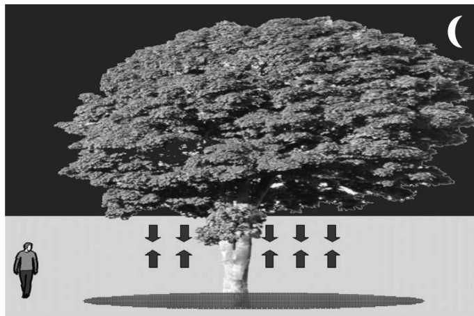
ภาพที่ 8: แสดงการแลกเปลี่ยนรังสีความร้อนระหว่างพื้นดินกับท้องฟ้าในกรณีที่มีการปลูกต้นไม้ชนิดอื่นที่ไม่มีการหุบใบในตอนกลางคืน ทำให้การแลกเปลี่ยนรังสีความร้อนเป็นไปได้ยาก
